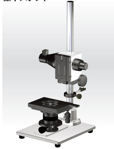
Z電動ステージ/ XY手動ステージ装着時
