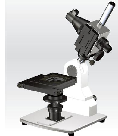
Z電動ステージ/ XY電動ステージ装着時
