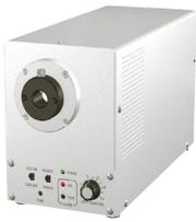
高輝度タイプのLED光源です。照度1,400,000lx(対標準約2.3倍)。ランプ寿命約30,000時間。外部調光対応(8bitデジタル/RS232C/LAN)。低反射の対象物を高倍率で観察する時や、観察距離が長い超長距離ズームレンズ使用時など、高い照度が必要な用途に最適です。
