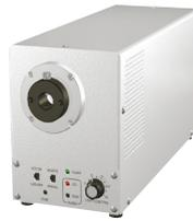
超高輝度タイプのLED光源です。照度1,800,000lx(対標準約3倍)。ランプ寿命約30,000時間。外部調光対応(8bitデジタル/RS232C/LAN)。観察距離が特に長い超長距離ズームレンズ使用時など、より高い照度が必要な用途に最適です。
