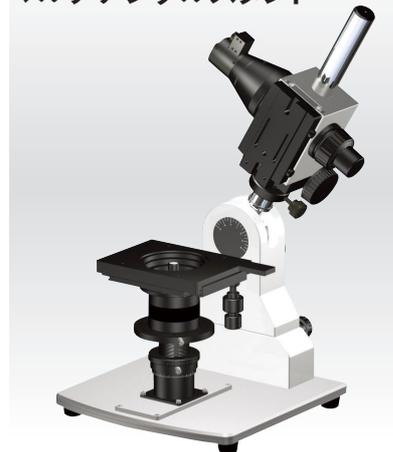
Z電動ステージ/ XY手動ステージ装着時
