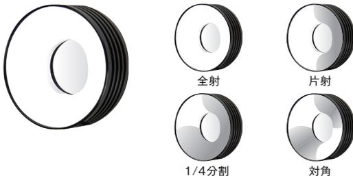
側射照明用のリング照明で、全照明、片側照明、1/4分割照明など照明パターンを自由に選択できます。これにより、従来の画一的な照明では見えなかったものが驚くほど見えるようになります。また、全射と同軸落射、片射と透過のミックス光など、様々な照明の組み合わせや調光が専用コントローラにより一元管理できます。
