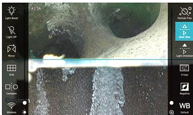
フロント/サイド デュアルビューを一画面に表示(ミラー装着時)
